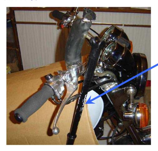
Insuffler un peu de vigueur à l'aide d'une pompe 4) Ouvrir les purges et actionner le levier, doucement sinon le liquide gicle dans la chambre et on en met partout en démontant.
