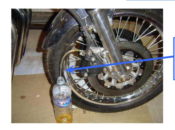
Prévoir purges sur les étriers 2) Démonter le couvercle et la membrane du maîtrecylindre, et mettre en place l'outil.
